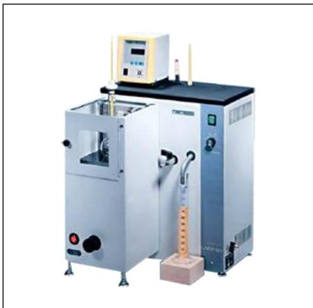
Предназначен для ручной энглеровской разгонки нефтепродуктов групп с 0 до 4, имеет встроенный электрический нагреватель с ручным управлением мощностью нагрева. Встроенный конденсор и водяная баня обеспечивают высокоэффективную конденсацию паров, баня оснащена индикатором уровня жидкости.
