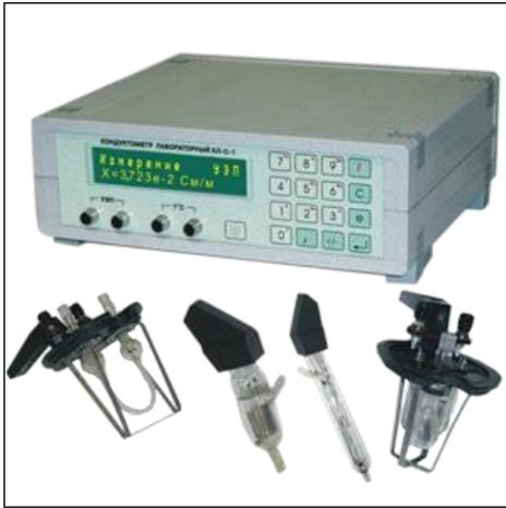
Предназначен для измерения текущей и приведённой к заданной температуре удельной электрической проводимости жидких сред. Может использоваться для анализа как неорганических кислот, щелочей, солей, так и чистых углеводородных жидкостей. Применяется для выполнения лабораторных химико-аналитических работ и в качестве средства метрологической поверки промышленных кондуктометров, солемеров и кондуктометрических концентратомеров.
