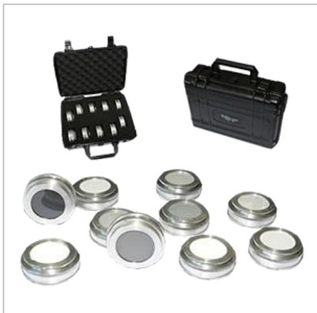
Комплект мер предназначен для использования в качестве меры спектрального коэффициента диффузного отражения (СКДО) для определения погрешности фотометрической шкалы и поверки шкалы длин волн фотометров и спектрофотометров в соответствии с ГОСТ 8.557-2007 и МИ 2060-90
