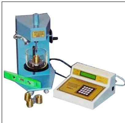
Пенетрометр ПНПц-03 служит для определения пенетрации парафинов и церезинов путем автоматического измерения глубины погружения в испытуемый образец стандартной по массе, форме и размерам иглы (ГОСТ 25771) при заданной температуре в течение заданного времени.
