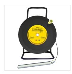
Электроуровнемером ЭУ называют такой измеритель уровня жидкости, который в принципе своего действия использует электроконтактный метод измерения. Уровнемер ЭУ является универсальным, так как может применяться для измерения уровня воды в скважинах с любым типом обсадной трубы (пластик, металл), а так же при отсутствии обсадной трубы, например для измерений в колодцах, емкостях и при других гидрогеологических работах.
