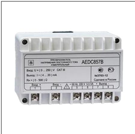
Измерительные преобразователи напряжения постоянного тока «AEDC857» с аналоговым токовым выходом и с интерфейсом RS-485 предназначены для измерения напряжения постоянного тока и преобразования измеренных значений в унифицированные сигналы постоянного тока и в цифровой кодированный сигнал для передачи на верхний уровень автоматизированной системы.
