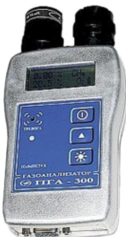
**Область применения:** Безопасность работ/Контроль ДВК горючих газов, Безопасность работ/Контроль ПДКр.з. вредных веществ
