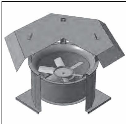
Крышный агрегат для системы противодымного подпора (ПД) устанавливается на кровле здания. Он обеспечивает прямую подачу наружного воздуха с надкровельного пространства в лестничные и лифтовые зоны, чем создает избыточное давление в лестничных, лифтовых и прочих зонах, не позволяя дыму поступить в эти помещения. При этом упрощается вентиляционная система и освобождается рабочее пространство на техническом этаже.
