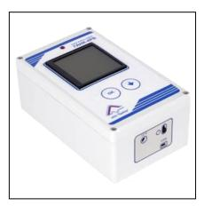
Газоанализатор ГАНК-4РБ предназначен для автоматического одновременного измерения концентрации до восьми загрязняющих химических веществ (3ХВ) с помощью встроенных датчиков, например: аммиака (NH<sub>3</sub>), бензола ( $C_6H_6$ ), диоксида азота (NO<sub>2</sub>), диоксида серы (SO<sub>2</sub>), оксида углерода (CO), сероводорода ( $H_2S$ ), суммы углеводородов ( $C_mH_n$ ) и формальдегида (HCOH).
