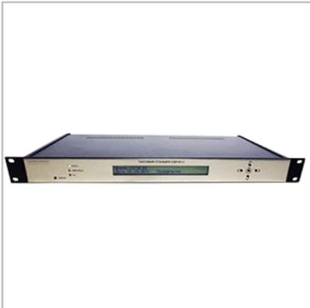
Часовая станция СВР-01 - устройство, предназначенное для управления и синхронизации вторичных стрелочных и цифровых часов, реле, компьютеров и других устройств локальных сетей, IT-систем и другого оборудования в системах часофикации. Используется в качестве системообразующего компонента в крупных, либо достаточно сложных системах единого времени.
