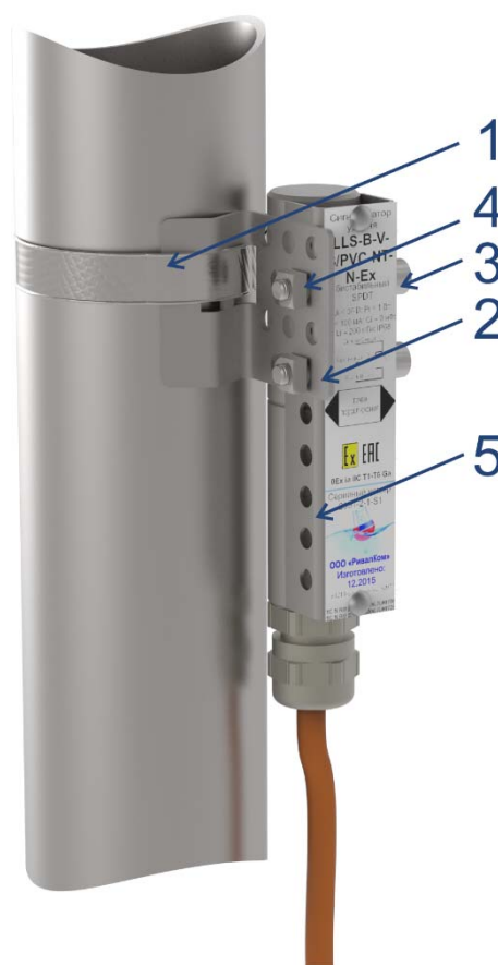
Рисунок 2.2 Монтаж сигнализатора на камере указателя уровня
