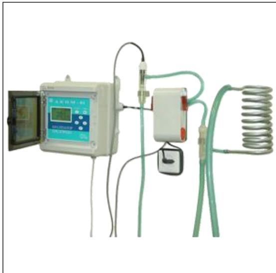
Газоанализатор АКПМ-1-01Г предназначен для производственного определения концентрации и/или парциального давления кислорода в газовых средах.
