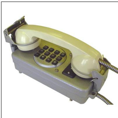
Судовые телефонные аппараты **ТАС-М-6К, ТАС-М-6 и ТАС-М-6ЦБ** предназначены для связи между абонентами корабельной и учрежденческой АТС при сопротивлении абонентских линий до 1500 Ом и напряжении питания от 24 до 60 В.
