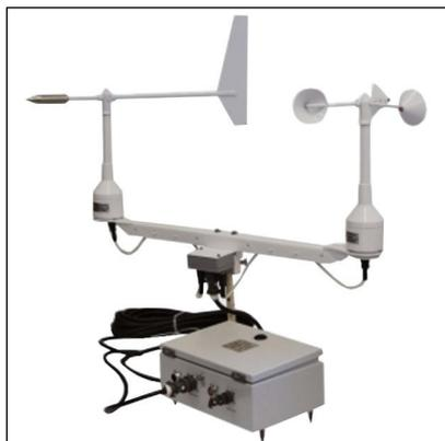
Анеморумбометр **Пеленг СФ-03** предназначен для дистанционного измерения параметров ветрового потока – мгновенной, максимальной и средней скоростей и направления ветра, регистрации и отображения информации на внешних устройствах.
