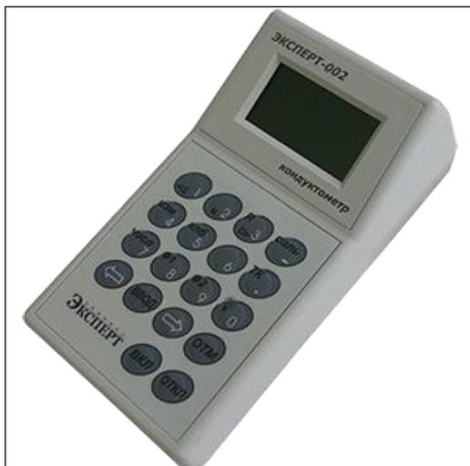
Кондуктометр **ЭКСПЕРТ-002** позволяет измерить удельную электропроводность (УЭП) и температуру (Т).
