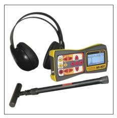
Кабелеискатель Успех-КБИ-406Н предназначен для определения местоположения и глубины залегания скрытых коммуникаций (кабельные линии, силовые и сигнальные кабели) на глубине до 6 м. Также может использоваться для проведения работ по поиску скрытой проводки. Оснащен режимом «свойчужой».
