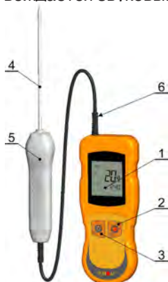
Рис. 1 Основные части прибора ТК-5.01С, органы управления
