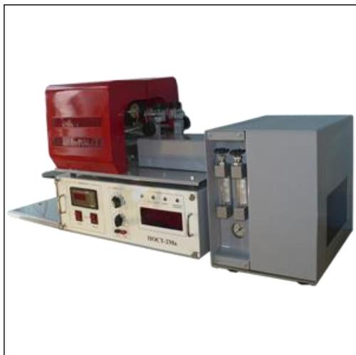
ПОСТ–2Мк предназначен для определения содержания общей серы в темных нефтепродуктах (включая масла, остаточные нефтепродукты, а также нефти, кокс и содержащие присадки) сжиганием в трубке.
