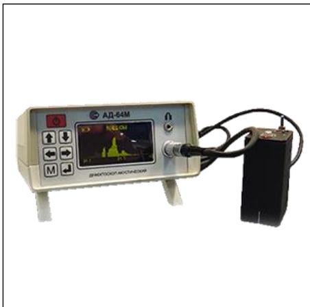
Акустический дефектоскоп АД-64М предназначен для обнаружения расслоений в слоистых пластиках и выявления дефектов соединений (преимущественно клеевых) в многослойных конструкциях из различных полимерных композиционных материалов (ПКМ) и металлов, применяемых в различных сочетаниях.
