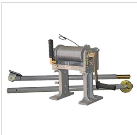
Гидрометрические лебедки ПИ-24М являются вспомогательным оборудованием при гидрологических наблюдениях и служат для погружения в воду на заданную глубину подвешенного на стальном тросе с токопроводящей жилой гидрологического прибора — вертушки, батометра, рамы или оправы с термометром и т.д.
