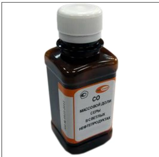
Стандартный образец предназначен для аттестации и контроля погрешностей методик измерений массовой доли серы в светлых нефтепродуктах методом сжигания в лампе по ГОСТ 19121-73, ASTM D 1266-98 и для градуировки рентгенофлуоресцентных анализаторов серы в нефтепродуктах.
