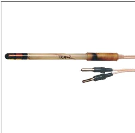
Термокомпенсатор автоматический ТКА-7 предназначен для компенсации изменения ЭДС электродной системы при изменении температуры измеряемого раствора и применяется для работы в комплекте с иономерами.
