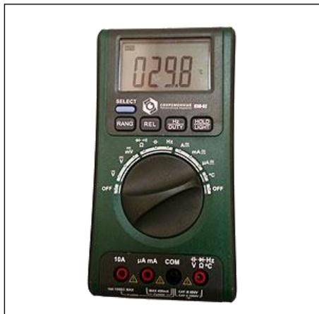
Приборы предназначены для осуществления измерения напряжения постоянного и переменного тока, силы тока, электрического сопротивления, емкости, индуктивности (в зависимости от модификаций набор функций может меняться) искробезопасных электрических цепей в подземных выработках угольных шах в соответствии с требованиями ГОСТ 30852.0, а также цепей постоянного до 1000В и переменного тока напряжением до 700В вне взрывоопасных зон.
