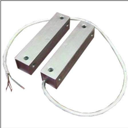
Датчики положения магнитогерконовые ДПМ-2, предназначены для блокировки ворот, железнодорожных контейнеров, ангаров, дверей вагонов, лифтов и других конструктивных элементов зданий и сооружений из магнитопроводных материалов (сталь, чугун, оцинкованное железо и т.д.) и немагнитопроводных материалов, на открывание или смещение с выдачей сигнала путем размыкания (переключения) сухого контакта геркона, а также в системах автоматики различных устройств.
