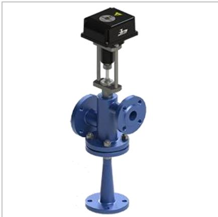
Регулирующие гидроэлеваторы для применения в системах теплоснабжения, для оптимизации расхода теплоэнергии, осуществляя качественно-количественное регулирования смешения теплоносителя прямой и обратной воды, играя роль эжекционных узлов смешения с регулируемым расходом рабочего потока посредством изменения сечения рабочего сопла (коэффициент смешения).
