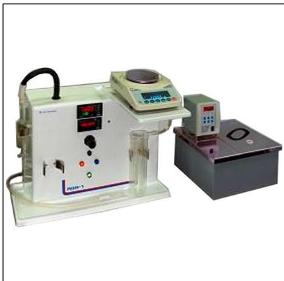
Аппарат **АДМ** предназначен для контроля за временем деаэрации, характеризующим степень деградации свойств турбинного масла из-за старения.
