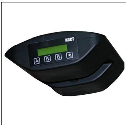
Стационарный измеритель запыленности **ИЗСТ-01** предназначен для измерения массовой концентрации пыли при контроле превышения предельно-допустимых концентраций в атмосфере, технологического контроле систем кондиционирования, вентиляционных систем и чистоты воздуха.
