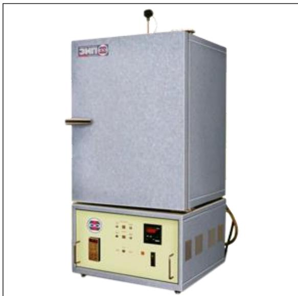
Прибор АТК-100300В предназначен для нагрева материалов и изделий, стойких при температуре, до которой они подвергаются нагреву и для испытания материалов на стойкость к термическому старению в воздухе.
