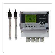
рН-метр двухканальный промышленный рН-4122. П предназначен для измерения активности ионов водорода (рН) или окислительновосстановительного потенциала (ОВП) и температуры анализируемой жидкости по одному или двум каналам.
