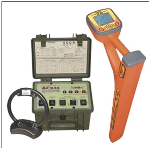
Трассоискатель Успех-АГ-309.60Н предназначен для точного определения местоположения и глубины залегания подземных коммуникаций (силовых и сигнальных кабелей, трубопроводов), на глубине до 10 м и удалении до 5 км от места подключения генератора поиска неисправностей кабельных линий, а также позволяет в кратчайший срок и с большой надежностью проводить обследование местности перед производством земляных работ и предотвращать повреждение инженерных коммуникаций.
