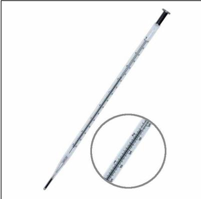
В комплект входят 2 ртутных стеклянных термометра для измерения температуры и влажности воздуха путем сравнения показаний сухого и смоченного термометра в аспирационном психрометре. Диапазон измерения температуры термометров от  $-30$  до  $+50^{\circ}\text{C}$  и от  $-25$  до  $+50^{\circ}\text{C}$ .
