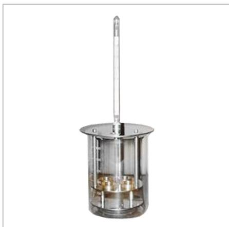
Предназначен для определения температуры размягчения битумов методом «кольцо и шар» по ГОСТ 11506-73
