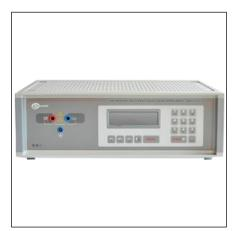
Калибраторы электрического сопротивления КС обеспечивают воспроизведение электрического сопротивления в диапазоне от 50 кОм до 10 ТОм.
