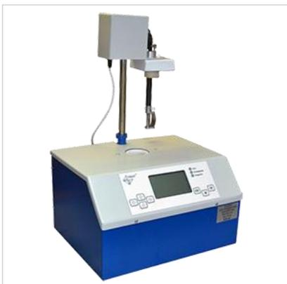
АТХ-04 предназначен для охлаждения рабочей пластины с нанесенным на нее слоем битума при периодическом ее сгибании и распрямлении, а также определения температуры, при которой на битуме появляются трещины или происходит излом образца.
