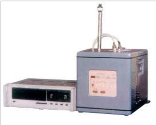
Калориметры В-08МА предназначены для определения удельной теплоты сгорания топлива: твердого по ГОСТ 147-95, жидкого по ГОСТ 21216-91 и газообразного по ГОСТ 10062-75.
