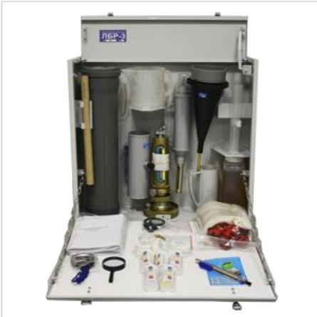
Лаборатория ЛГР-3 предназначена для определения параметров в полевых условиях качества бурового глинистого раствора.
