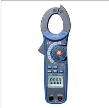
DT-3351 – серия профессиональных токовых клещей для измерения постоянного и переменного тока. Измеряют истинное среднеквадратичное значение (True RMS) переменного тока и напряжения, а также обладают различными дополнительными функциями, такими как измерение сопротивления, емкости, диодный тест, и т.п. Также с помощью токовых клещей DT-3351 можно измерять пусковой ток двигателей, приборов освещения и т.д.
