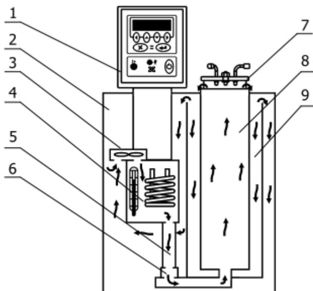
Конструкция термостата состоит из блока регулирования температуры и корпуса, внутри которого расположены: основная 2, рабочая 8 и дополнительная 9 ванны. В основной ванне 2 расположены блок регулирования 1 с выходной 5 трубкой и соединительная муфта 6.
