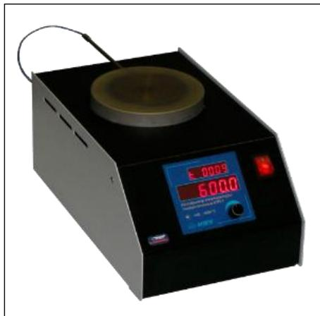
Калибраторы температуры поверхностные КТП-1 предназначены для воспроизведения температуры поверхности в диапазоне +40... +600°С.
