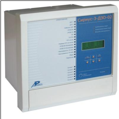
Устройство микропроцессорной защиты «**Сириус-3-ДЗО-02**» предназначено для выполнения функций основной дифференциальной защиты силового трансформатора (автотрансформатора) и ошиновки класса напряжения 6-220 кВ (в том числе в случаях присоединения их к системе через два выключателя).
