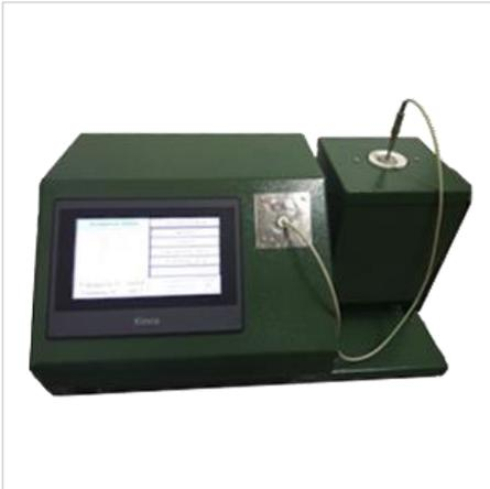
Аппарат АТЗ-02 предназначен для охлаждения пробы нефтепродуктов с заданной скоростью и автоматического определения температуры, при которой наклоненная проба остается неподвижной.
