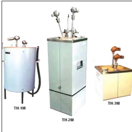
Термостаты нулевые предназначены для создания точки 0°С при проверке и градуировке термометров в лабораторных и цеховых условиях.
