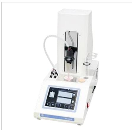
Автоматический аппарат ТПЗ-ЛАБ-22 предназначен для проведения классического анализа по определению температуры помутнения, потери текучести и застывания нефтепродуктов в соответствии со стандартами ГОСТ 20287 (метод А), ASTM D5950, ASTM D5771.
