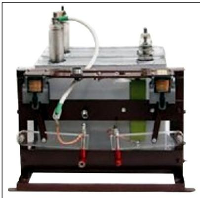
Генератор акустических ударных волн **ГАУВ-6** служит для поиска акустическим методом мест повреждения кабельных линий с переходным сопротивлением R 500 Ом. Генератор работает совместно с приемником П-806 с акустическим датчиком.
