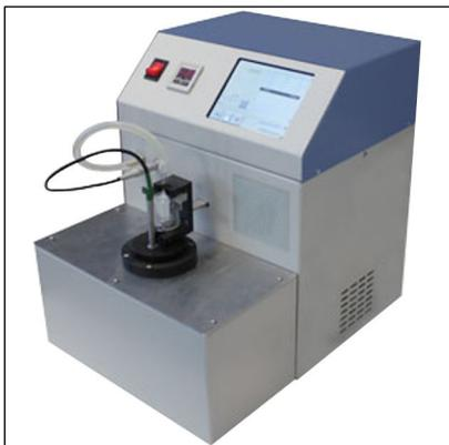
Автоматический аппарат **ПТФ-ЛАБ-11** предназначен для определения предельной температуры фильтруемости на холодном фильтре в соответствии с ГОСТ 22254-92, ГОСТ Р 54269-2010, ASTM D 6371 и другими аналогичными стандартами в диапазоне температур от -60 °С до комнатной.
