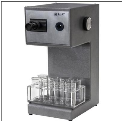
Колориметр **ЦНТ** предназначен для инструментального обеспечения ГОСТ 20284 «Нефтепродукты. Метод определения цвета на колориметре ЦНТ» и изготовлен в соответствии с международными стандартами ASTM D1500, DIN 51578, ISO 2049.
