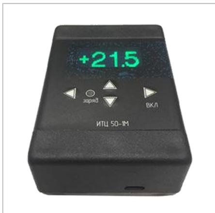
Измеритель температуры цифровой ИТЦ50-1М (в дальнейшем измеритель) предназначен для измерения температуры железнодорожных рельсов, а также других металлических конструкций.
