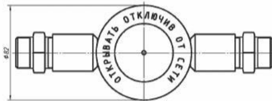
Рис.2. Извещатель ИП103–1В с головкой из стали 12Х18Н10Т, кабельные вводы для трубной прокладки кабеля (вариант кабельного ввода – для прокладки бронированного кабеля)
