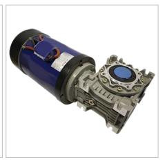
Мотор-редуктор состоит из коллекторного двигателя постоянного тока и червячного редуктора. Вращение от двигателя к редуктору передается червячной передачей. Максимальный крутящий момент – 780 кг\*см.
