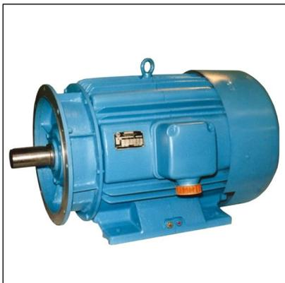
Трехфазные общепромышленные асинхронные электродвигатели ремонтной серии **АО2-9** с короткозамкнутым ротором закрытого исполнения предназначены для продолжительного режима работы от сети переменного тока. Форма исполнения IM 1001, IM 1002, IM 2001, IM 2002, IM 3011, IM 5010. Высота оси вращения 280 мм.
